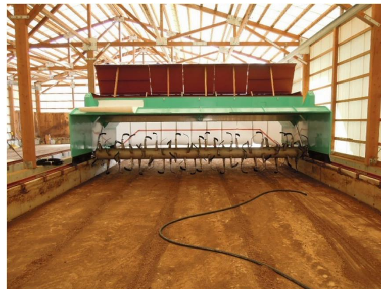
一次発酵処理施設、ロータリー攪拌機
