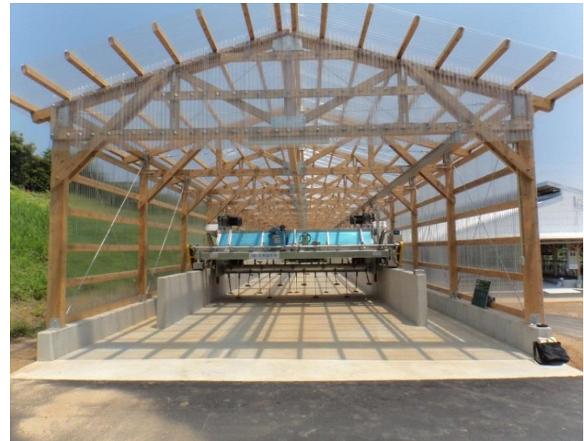
家畜排せつ物処理施設（ロータリー式攪拌機）
